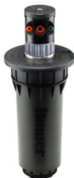
G85 - Teilkreis bis 28,7m; bis 13,54m³/h 3,4 bis 6,9bar
