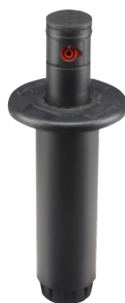
G70 - Vollkreis bis 22,9m; bis 7,66m³/h 3,4 bis 6,9bar
