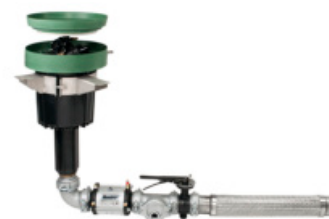
Montagebeispiel für ST-1600B für den Einbau im Polymerbetonkasten, mit angebauter Stabilisierungskonsole, verfügbare Gummiabdeckung oben, Anschluss- und Absperrgarnitur, Steuerventil, Abgang f. Schnell- kupplungsventil, 1" Entleerungsventil
