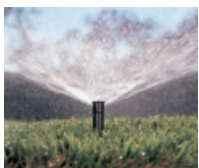
Mit Druckregulierung: Größere Tropfen, geringerer Windangriff
