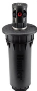
G80 - Vollkreis bis 29,6m; bis 13,29m³/h 3,4 bis 6,9bar
